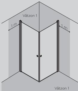
Skruvinfästningar i våtzon 1 ska göras i betong eller annan massiv konstruktion (a), träreglar, träkörningar (b) eller i konstruktion som är provad och godkänd för infästning, till exempel skivkonstruktion (c). Se exempel på godkända konstruktioner på säkervatten.se. Alla infästningar i våtzon 1 och 2 ska tätas. Material för tätning ska fästa mot underlaget och vara vattenbeständigt, mögelresistant och åldersbeständigt.
