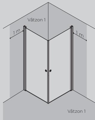
**SE** Skruvinfästningar i våtzon 1 ska göras i betong eller annan massiv konstruktion (a), träreglar, träkortlingar (b) eller i konstruktion som är provad och godkänd för infästning, till exempel skivkonstruktion (c). Se exempel på godkända konstruktioner på säkervatten.se.
