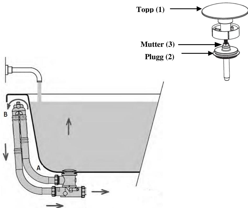
Når man fyller ett Nemo kar med skjult overløp vil vannet også stige i en slange (A) som går fra avløpet og opp langs kanten av karet. Ved ett vist punkt vil vannet begynne å renne ut igjen (B). Man kan altså ikke fylle karet med mer vann enn overløpet tillater.
